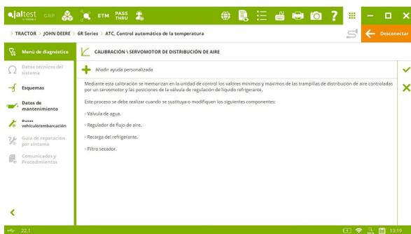
Sistema de calefacción automática **ATC** en modelos **6R Series**, calibración de la válvula de calefacción del agua y calibración del servomotor de distribución del aire.
